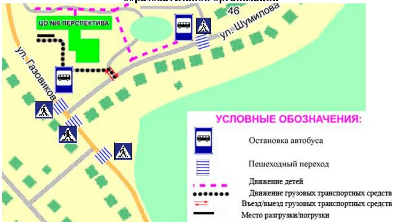
**5. План-схема пути движения транспортных средств и детей при проведении дорожных ремонтно-строительных работ вблизи образовательной организации**
